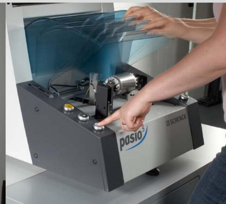
Schutzabdeckung für Rotoren mit scharfkantiger Oberfläche
