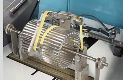
Bandantrieb von oben für das Auswuchten von Radiallüftern (Pasio 5)
