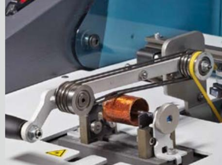
Tangentialantrieb für sehr leichte Rotoren wie beispielsweise eisenlose Anker (Pasio 05)
