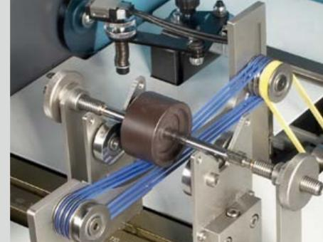
Auswuchten von Permanentmagnetankern mit 3 Antriebsriemen (Pasio 5)
