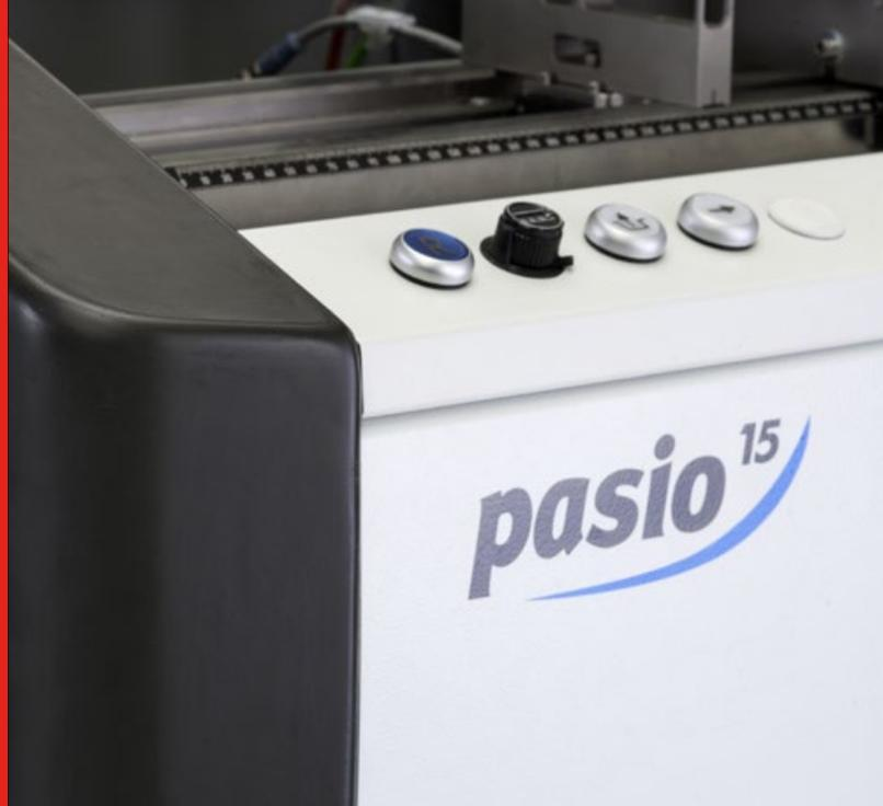
Der zentrale Maschinenrahmen der Pasio 15 ist aus Mineralguss gefertigt. Dieser moderne Werkstoff dämpft Schwingungen um bis zu zehn Mal stärker als Grauguss und ist dadurch wie geschaffen für den ruhigen Lauf einer Auswuchtmaschine. Die Maschine ist damit deutlich unempfindlicher gegenüber störenden äußeren Einflüssen und benötigt kein eigenes Fundament.
