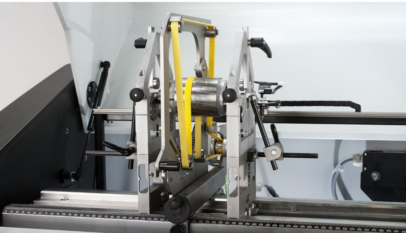
*Amagnetische Ausführung aller Komponenten im Prüfraum*
