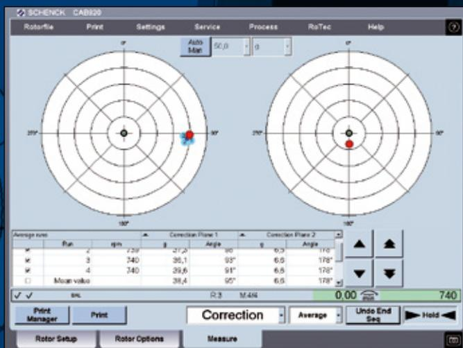
Mit der Option Messwertmarkierung und Mittelwertbildung über mehrere Läufe lässt sich auch das Unwuchtverhalten instabiler Rotoren beurteilen und korrigieren.
